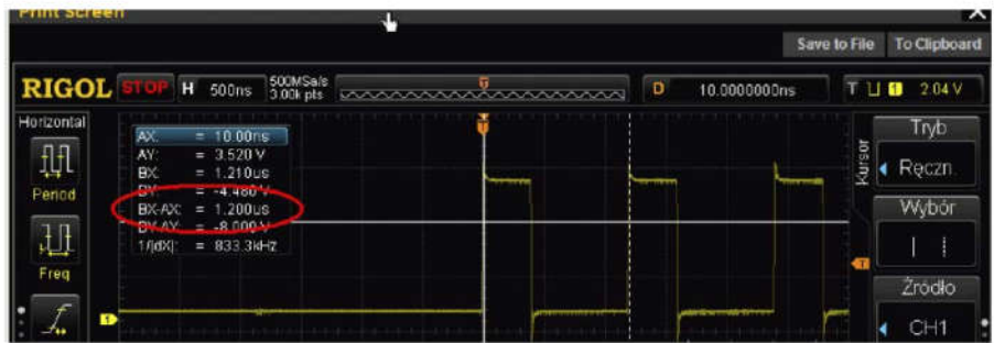
Rysunek 8. Zmierzona maksymalna przepływność interfejsu UART
