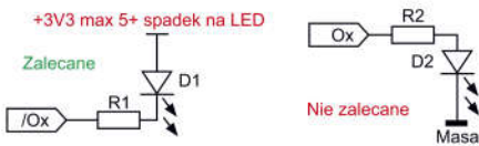
Rysunek 9. Zalecany sposób dotychczasania diod LED
