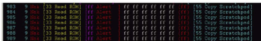
Rysunek 7. Dane wysłane przez host, brak sygnału presence
